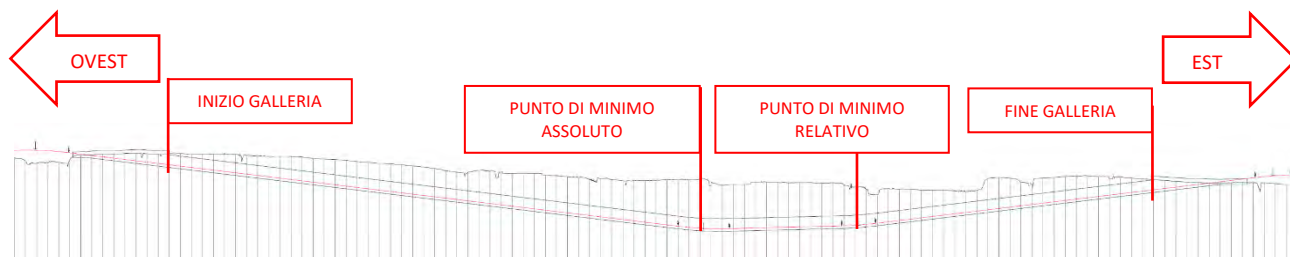
Figura 59 – Stralcio profilo longitudinale interramento linea in corrispondenza del centro abitato di Imola
